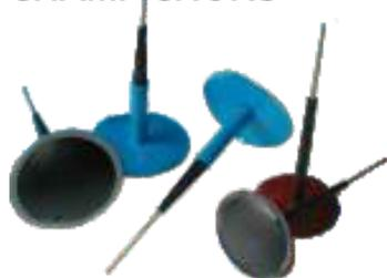
Les champignons permettent des réparations de la plus grande qualité sur le flanc, l'épaulement et le sommet des pneus à carcasse radiale métallique ou à carcasse diagonale, avec ou sans chambre. Une gomme de liaison recouvre la tige et l'embase de la cheville pour assurer l'adhérence maximale et l'étanchéité parfaite dans les pneus sans chambre.
