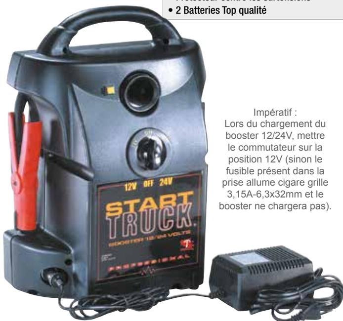
Impératif : Lors du chargement du booster 12/24V, mettre le commutateur sur la position 12V (sinon le fusible présent dans la prise allume cigare grille 3,15A-6,3x32mm et le booster ne chargera pas).
