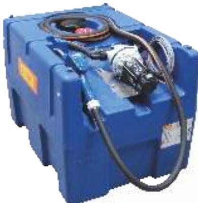
Station mobile pour le ravitaillement des engins sur chantier ou dans les grandes zones d'exploitations. Réservoir de 220L en polyéthylène opaque. Pompe 12V à membrane. Dispositif pour le rangement du flexible de distribution. Dimensions : 800x600x590
